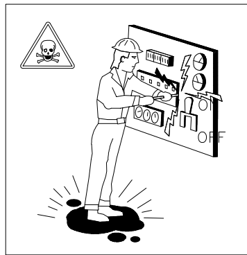
REPARACION DE EQUIPOS BAJO TENSION
